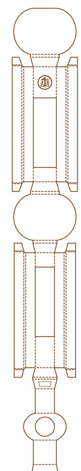
Kostru obalu držící dva díly papírové voštiny tvoří pás poskládaný z jednoho kusu třívrstvé vlnité lepenky o tloušťce 2mm.
